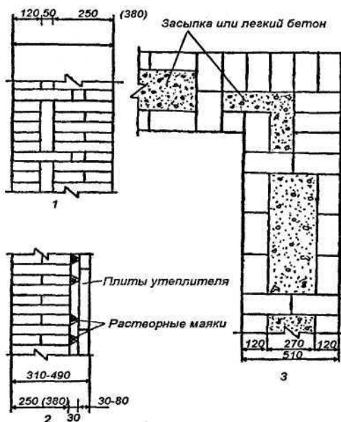
Рис. 11. Стены бани из кирпича и камня:
